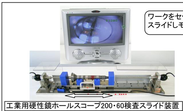
ワークをセットし、スコープを左右に取り付け、スライドしモニターで検査する装置も製作します。
